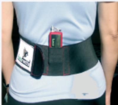
Le capteur placé à la ceinture mesure précisément et enregistre les caractéristiques biomécaniques de la marche sur tapis roulant ou sur le sol. Le logiciel Locometrix® Podologie calcule les paramètres dynamiques de la marche, qui sont interprétés pour évaluer automatiquement en quelques minutes :
