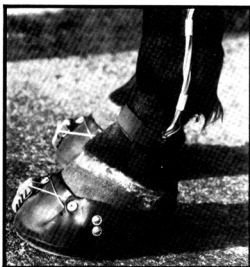
Figure 1: L'hipposandale munie de capteurs de force et d'accélération est fixée sur un pied antérieur.
